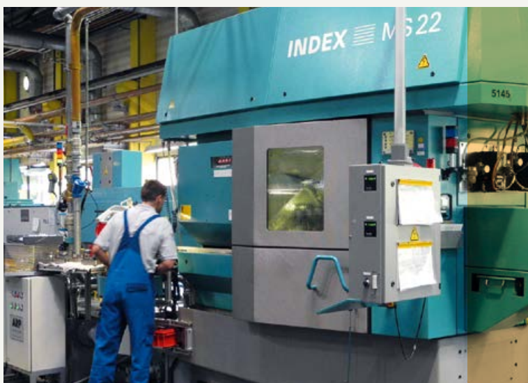
Der Maschinenpark umfasst mehr als ein Dutzend Mehrspindelmaschinen von INDEX, die alle mit SINUMERIK 840D-Steuerungen ausgestattet sind.
