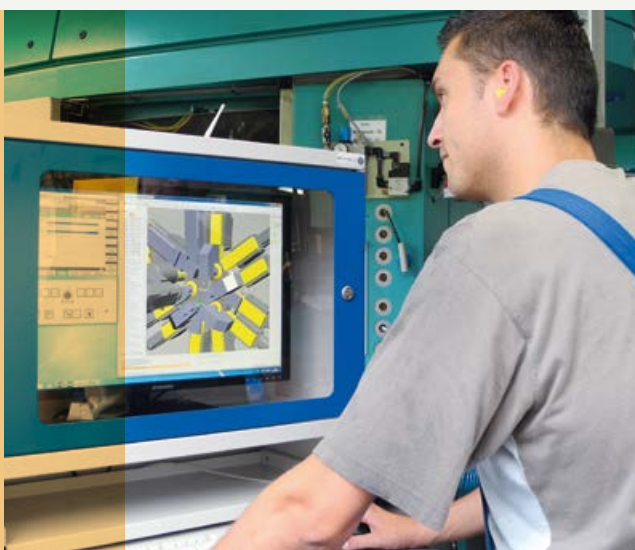
Ein mobiler Arbeitsplatz erlaubt es den Einrichtern, die Mehrspindelbearbeitung vorab an der virtuellen Maschine zu optimieren.
