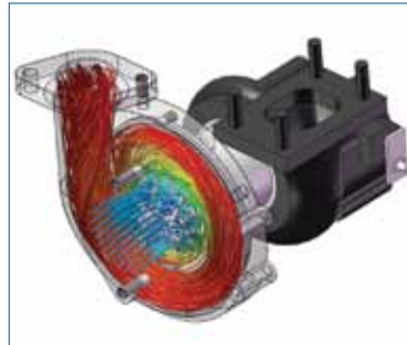
FloEFD zeigt das visuelle Ergebnis der Analyse des Strömungsfeldes in verschiedenen Formen; hier als Strömungslinien, die vom Ursprung bis zum Ausgang verfolgt werden können
