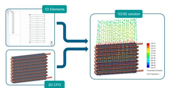
Das 1D-Elemente-System wird daher verwendet, um die Simulation im Inneren der Rohre durchzuführen, während die 3D-Simulation auf der Außenseite der Rohre läuft. Die 2D-Flächen zwischen dem 1D-System und der 3D-Simulation bilden die Grenzen zwischen den beiden Simulationen, wobei der Wärmeübergang zwischen der 1D- und der 3D-Simulation in einer einzigen Simulation gelöst wird. Die 1D-Elemente basieren auf der Simcenter Flomaster-Technologie.
