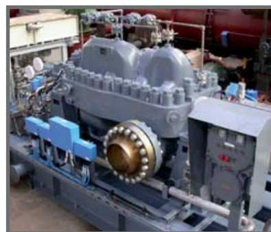
Mehrstufige Kreiselpumpe aufgebaut auf einer Grundplatte. Das Foto zeigt deutlich die Spannelemente, mit denen Ober- und Unterteil der Pumpe zusammengehalten werden.
